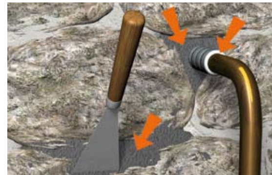
Situation après travaux : colmatage des voies d'eau.
